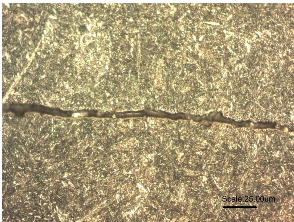
Figura 33 - Micrografia da região central do corpo de prova. Aumento de 500x e ataque com Nital 2%
