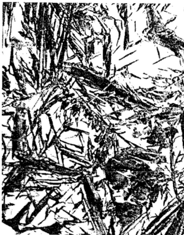
Figura 4 - Microestrutura rica em martensita lenticular ou em placas. A região escura, em formato semelhante à agulhas é a martensita lenticular enquanto as regiões brancas correspondem a austenita retida (CALLISTER JR., 2008).
