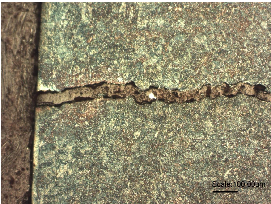
Figura 31 – Fotografia da fronteira entre a baquelite e a trinca. Aumento de 100x e ataque com Nital 2%
