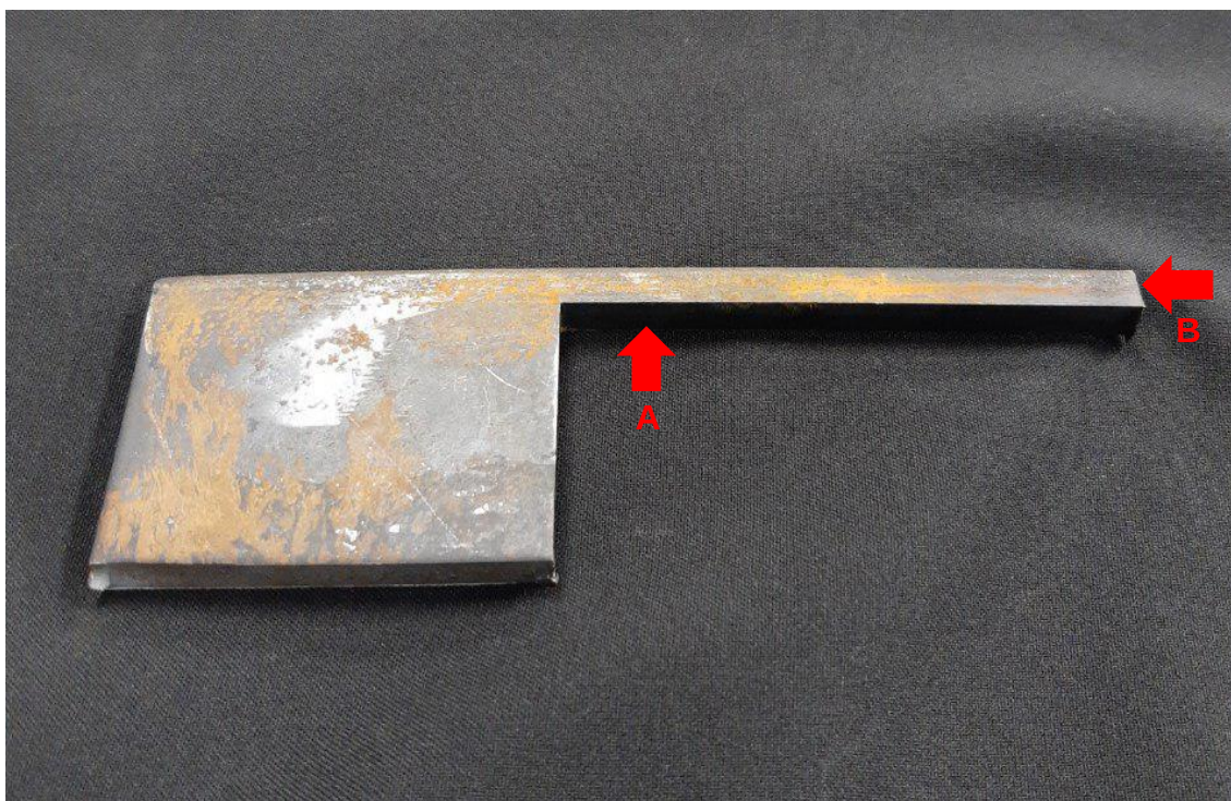
Figura 18 - Fotografia da amostra fornecida pelo fabricante da chapa de aço. As regiões "A" e "B" indicadas foram as faces escolhidas para a análise metalográfica.
