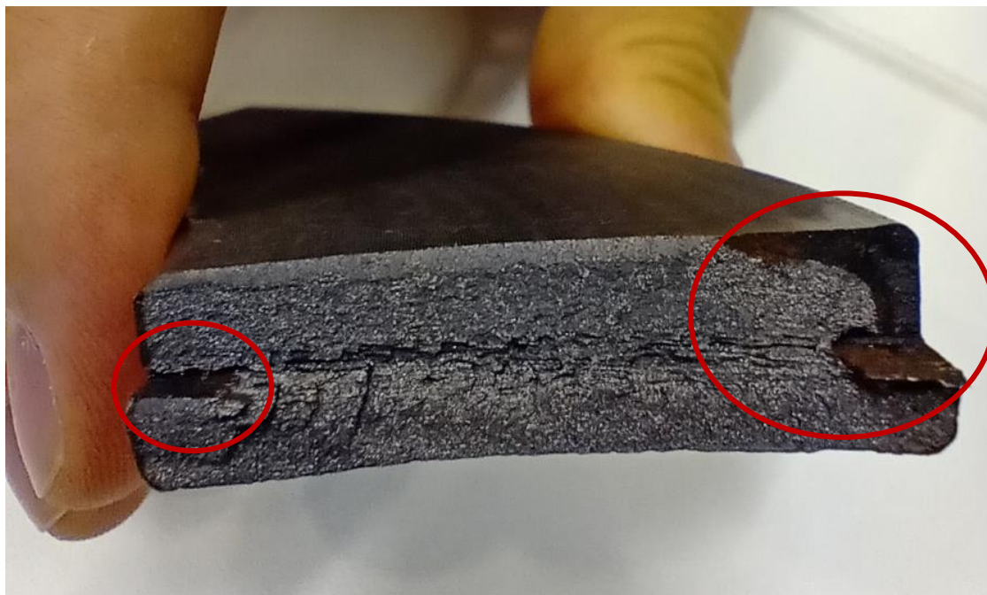
Figura 28 - Fotografia da trinca da Amostra 2. É possível observar, nas regiões destacadas, dois focos de oxidação
