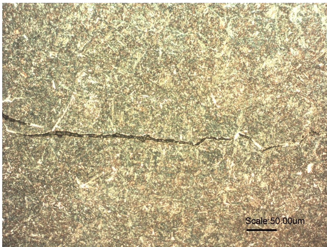
Figura 32 - Micrografia da região final da trinca. Aumento de 200x e ataque com Nital 2%
