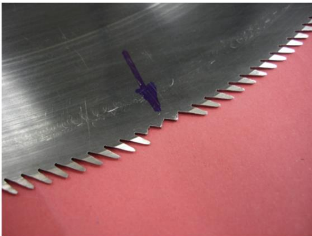
Figura 14 – Fotografia da amostra enviada para análise. Todas as falhas ocorreram na mesma posição, nos três casos visíveis (MONLEVADE et al., 2013)
